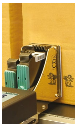
Jet d'encre cartons Minitouch - Jusqu'à 4 lignes
